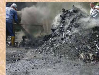
Nach ca. 1 - 3 Wochen, je nach Meilergröße, ist der Verschwelungsprozess beendet. Jetzt kann der fertige Meiler mit Hilfe von Ziehhaken oder Störhaken aufgebracht werden. Die fertige Kohle wird mit dem Kohlenrechen aus dem Meiler gezogen und anschließend mit Wasser gelöscht. Nach Abkühlung kann die Kohle verladen werden.
