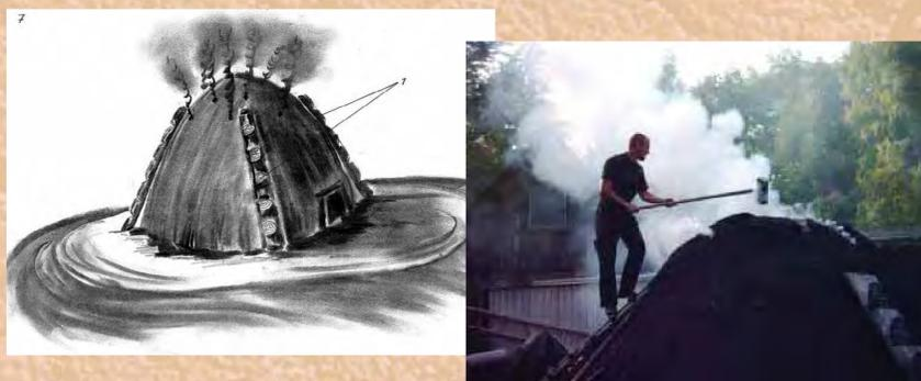
Bei Bedarf muss über die Meilerstiege (1) durch den Verschwelungsprozess entstandene Hohlräume mit Hilfe des Traugott (Rasenklöpfer) mit Holz aufgefüllt werden.
