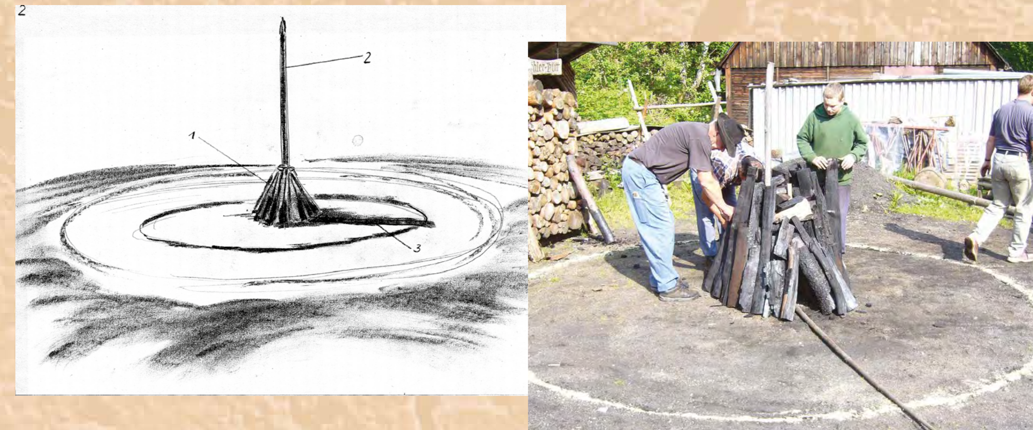
Aufbau des Quandelschachtes (1) Um die Richtstange (2) wird trockenes harzhaltiges Holz geschichtet. Auf einer Seite wird das Quandel für das Anzünden offen gelassen. Eine Holzstange (3) markiert den Zündkanal.
