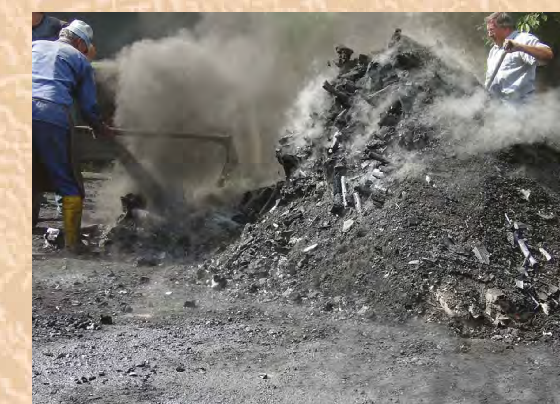
Nach ca. 1 - 3 Wochen, je nach Meilergröße, ist der Verschmelungsprozess beendet. Jetzt kann der fertige Meiler mit Hilfe von Ziehhaken oder Störhaken aufgebracht werden. Die fertige Kohle wird mit dem Kohlenrechen aus dem Meiler gezogen und anschließend mit Wasser gelöscht. Nach Abkühlung kann die Kohle verladen werden.
