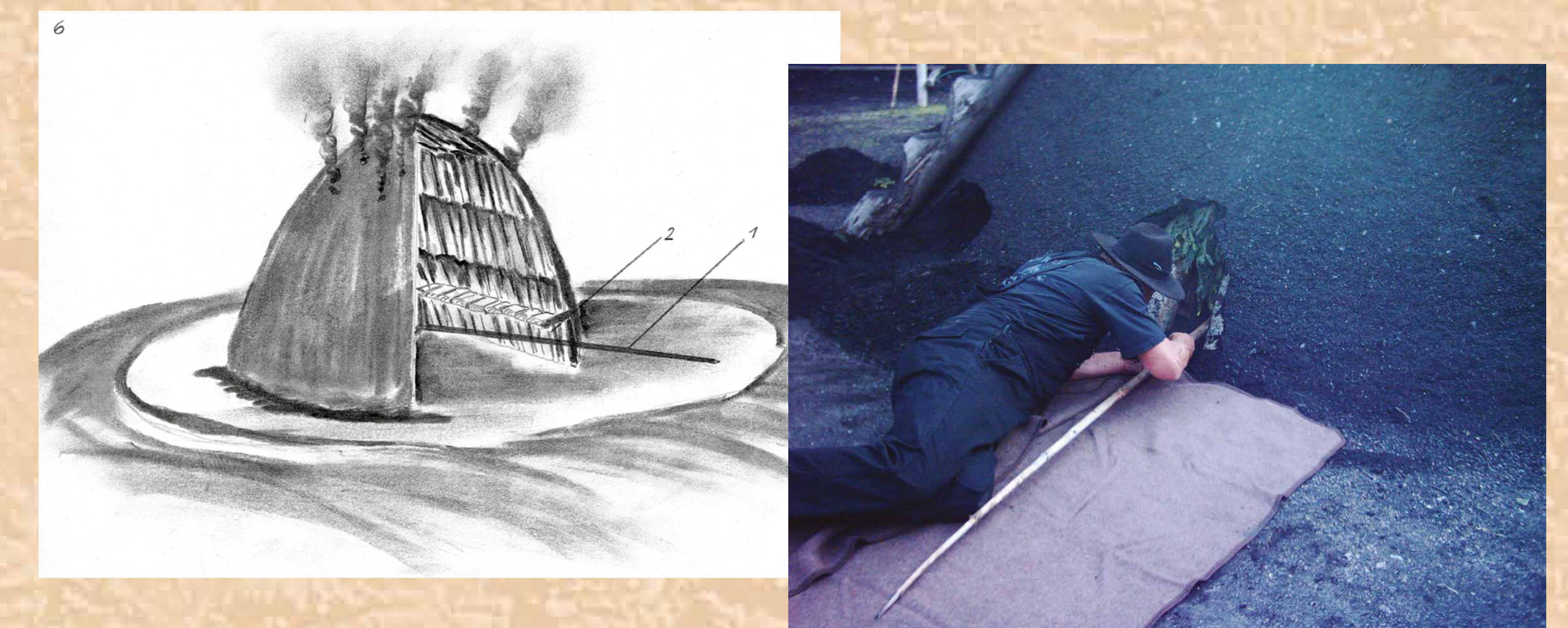
Zünden des Meilers mit der Zündstange (1) durch den Zündkanal (2). Nach dem Zündvorgang wird der Zündkanal mit Holz verschlossen.
