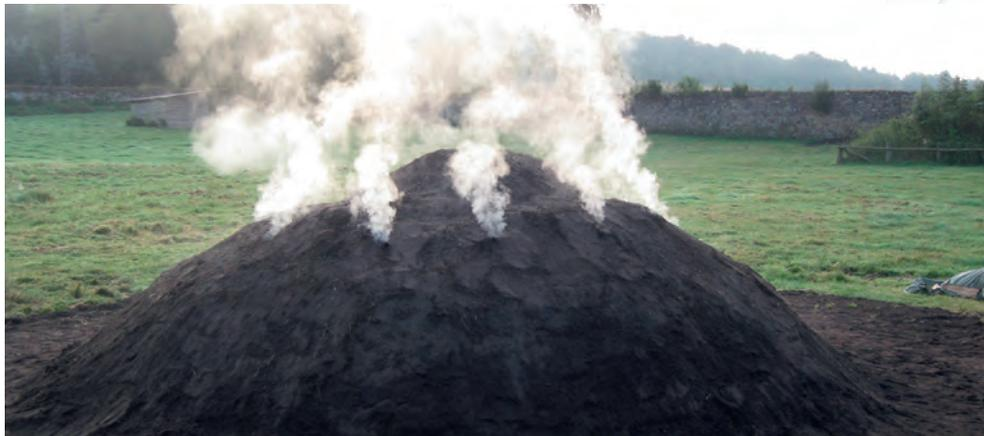
Das geschichtete Holz wird durch einen zur Meilermitte führenden Kanal am Meilerfuss oder durch einen Schacht (den Quandelschacht) auf dem Meilerkopf in der Mitte des Meilers entfacht. In einer
