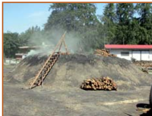
Meiler in Betrieb
