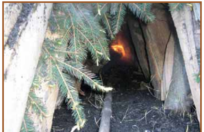
Blick in den Zündkanal
