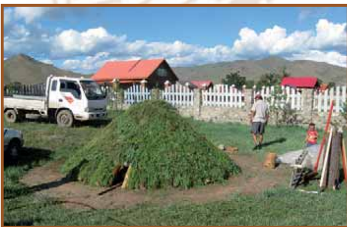
Meiler mit Möhrenkraut abgedeckt
